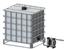
Bomba instalada debajo de la cabeza (aspiración positiva)
